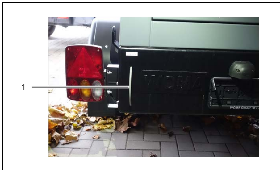
Рис. 19: выпуск воздуха из ресивера
